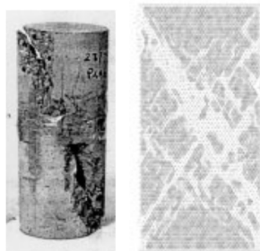
Рис. 12: Применение метода Псахье для моделирования разрушения бетона
