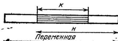
где:  $\eta$  — значение первого  $\langle \text{выражения} \rangle$ , т. е. номер начального элемента поля;  $\kappa$  — значение второго  $\langle \text{выражения} \rangle$ , задающего длину поля;  $\eta - \kappa + 1$  — номер последнего элемента поля.
