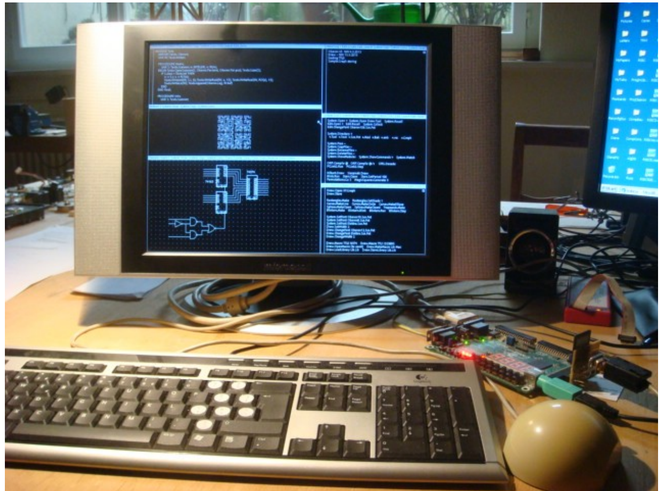
«Церера» на ПЛИС Xilinx Spartan-3 Выполняется система Оберон, 2013
